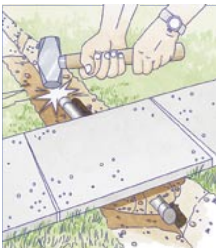
Per il passaggio sotto una pavimentazione usare un martello per far passare un tubo zincato chiuso alle due estremità.
