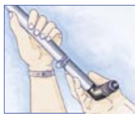
B. Tubo di Polietilene: 1. Mettere l'anello su tubo e poi inserire il raccordo a pressione.
