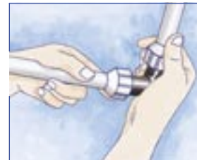
2. Spingere il tubo per far passare la guarnizione. Inserire l'estremità del tubo nel raccordo ed avvitare il dado di compressione.
