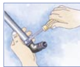
Tubo di Polietilene: 2. Stringere l'anello attorno al tubo e al raccordo.
