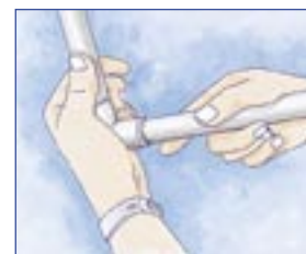
2. Inserire il tubo nell'unione e pulire l'eccesso di colla.
