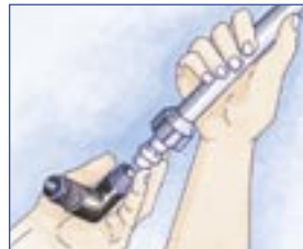
C. Unendo tubi in Polietilene con raccordi a pressione 1. Inserire l'estremità del tubo nel raccordo ed avvitare il dado di compressione.
